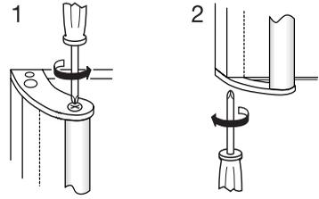
**10.** Отвинтить верхнее крепление ручки от дверцы (3) и привинтить его к дверце снизу справа (4).
